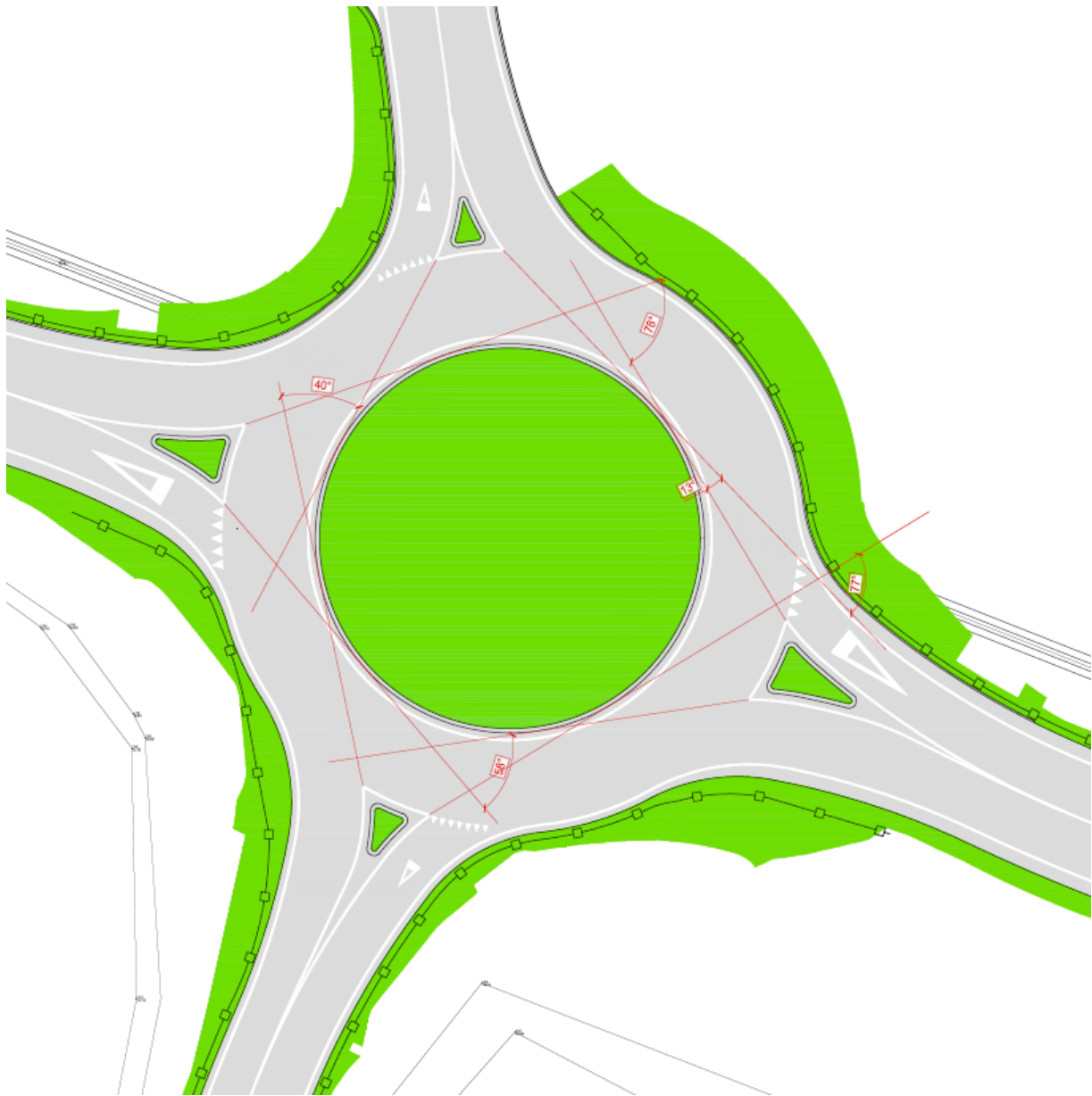
Figura 8: deviazione delle traiettorie rotatoria
