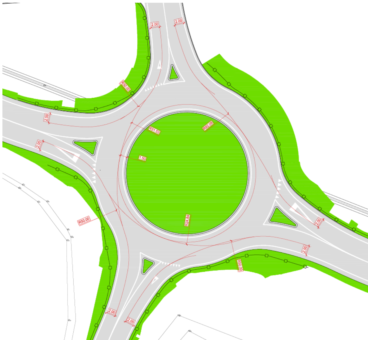
Figura 9: verifica deflessione traiettoria secondo Studio pre-normativo rotatoria
